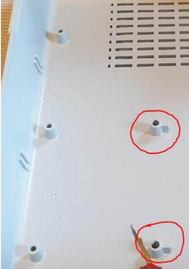
Abb 3: Abstandshalter zur Befestigung des Schaltnetzteils
