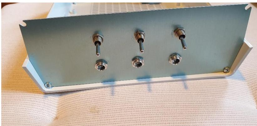
Abb 2: Gehäuse-Vorderseite mit Ausgangsbuchsen und Wippschaltern
